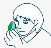
高倍率ルーペの見方 目につけて「覗く」ように「片目」で見る
