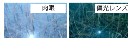
偏光レンズは乱反射された光をカット
